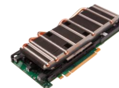
Nvidia Tesla M2050 (Fermi) 1 GPU, 448 cores 6 GB, 515 Gflop/s 0.011 byte/flop
